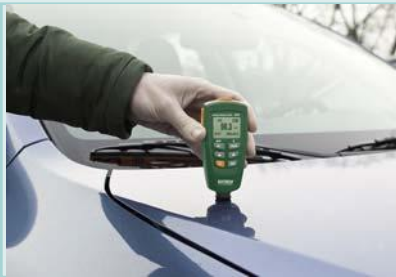
Midiendo el espesor de la pintura de un coche
